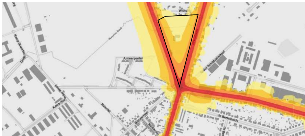
Figuur 53 Links: Lden Wegverkeer hoofdweggen (2016)
